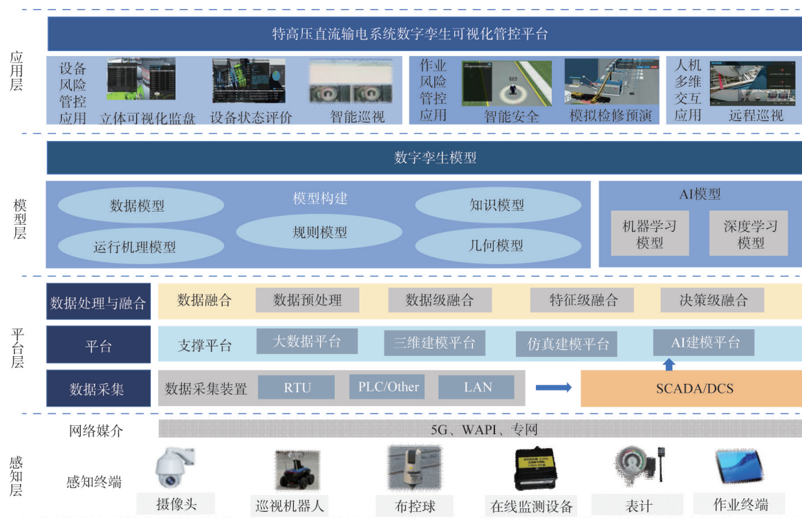
图3 特高压直流输电系统数字孪生总体框架
