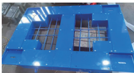
图 12 变压器粒子阻尼器样机
