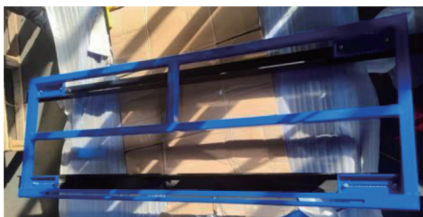
图 13 母排粒子阻尼器样机
