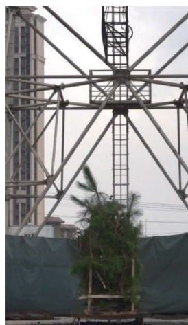
(a) 松树树冠火模拟试验平台
