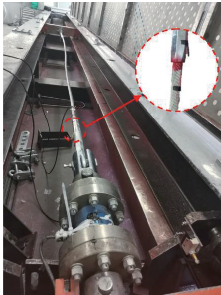
图4 拉伸实验布置图
