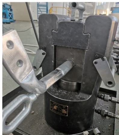
(d) 铝管与导线压接
