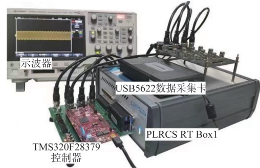
图 12 硬件在环实验测试平台
